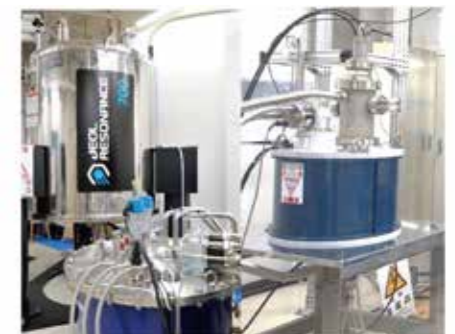
図2 超高感度DNP-NMR装置。極低温でNMRを観測する超伝導マグネット(左)とテラヘルツ波光源であるジャイロトロン(右)
