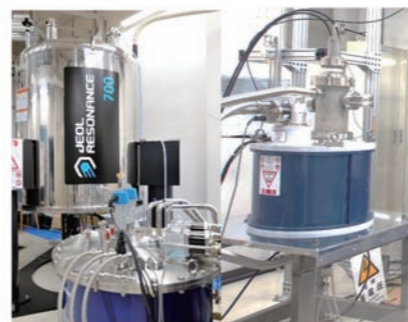
図2 超高感度DNP-NMR装置。極低温でNMRを観測する超伝導マグネット(左)とテラヘルツ波光源であるジャイロトロン(右)
